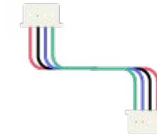
Verbinde den Calliope mini mit Hilfe des **Grove-Kabels** mit der MotionKit Platine. Das Grove-Kabel wird in den **A0-Anschluss** auf dem Calliope mini gesteckt sowie in einen der Grove Anschlüsse auf der MotionKit Platine.
