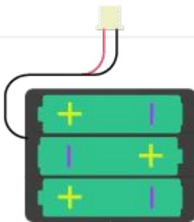
Verbinde den Stecker des **Batteriefachs** mit der MotionKit Platine. Fixiere das Batteriefach mit dem **doppelseitigen Klebestreifen**.
